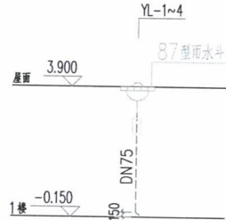
屋面雨水排水系统原理图
